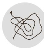
La ligne s'élève de 200 mètres au moyen de 3 boucles en spirale formant un 8, permettant de voir le train trois fois au même endroit.
